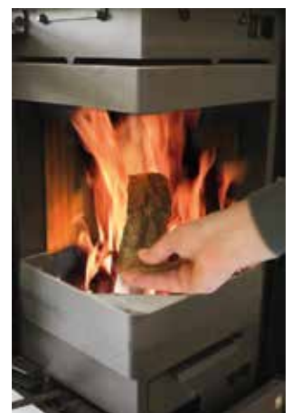
Feuerintensität über die Luftschieber regeln. Zum Nachlegen bitte immer nur maximal 2 Holzscheite auflegen.
