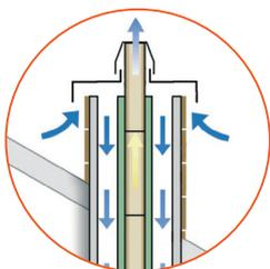
Frischlufte wird von der Schornsteinmündung über den Rundluftspalt der Feuerstätte zugeführt. Durch die konzentrische Anordnung von Luftschacht und Abgaszug wird die Verbrennungsluft auf ihrem Weg von außen zur Feuerstätte vorgewärmt. Diese Wärmerückgewinnung über die gesamte Bauhöhe des Schornsteinsystems verbessert den Wirkungsgrad der Anlage erheblich.
