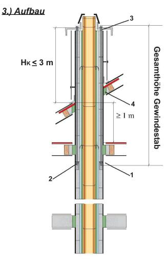
Um eine Höhe Hk ≤ 3 m über Dach bei Schornsteinen oder Abgasanlagen zu erreichen, sind die Spannstäbe über zwei Aussteifungspunkte zu versetzen. Diese Punkte müssen mind. 1,00 m auseinanderliegen.
