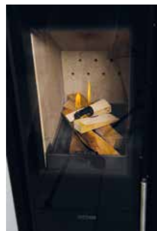
Lüftungsschieber auf Stufe II. Tür schließen. Das Feuer brennt von oben nach unten. Vorteil: es entsteht so weniger Rauch.
