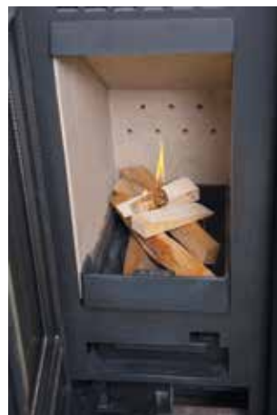
Lüftungsschieber auf Stufe II. Tür schließen. Das Feuer brennt von oben nach unten. Vorteil: es entsteht so weniger Rauch.
