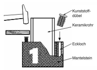
Mantelstein-Ecklöcher überprüfen und von eventuellen Betongraten befreien. Kunststoffdübel senkrecht einschlagen. Insbesondere bei verengten Ecklöchern und bei kalter Witterung ist ein Schutzholz empfehlenswert.
