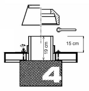
schrauben. Mit dem beigefügten Einweg-Ringschlüssel festschrauben, bis alle Metallscheiben die Gummischeiben gleichmäßig zusammendrücken. Keramik-Abdeckschürze mit Säurekitt auf der Rohrsäule aufkitten bzw. Metall-Abdeckschürze auf das Rohr stecken.
