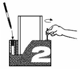
Stockschraube per Hand mit der Spitze nach unten in den Kunststoffdübel bis zum festen Sitz einschrauben.
