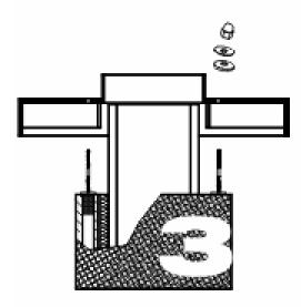
Abdeckplatte über alle Stockschrauben herablassen und zentrieren. Das PLEWA-Keramikrohr muss bei Verwendung einer Keramikschürze als auch bei Verwendung einer Edelstahlschürze 15 cm über die Oberkannte der Abdeckplatte herausragen. Unterlegscheiben einfädeln und Hutmuttern auf-
