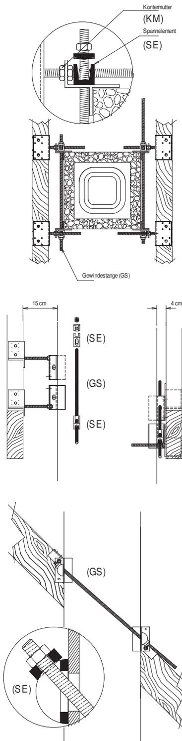
Im verpackten Lieferzustand ist die einstellbare Schornsteinkopfhalterung einsatzbereit und für einen Einbau **AUF DEN SPARREN** vormontiert und entsprechend gekennzeichnet.
